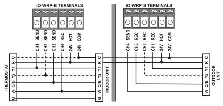
HEAT PUMP UPGRADE WITH NO WIRES TO OUTDOOR UNIT
